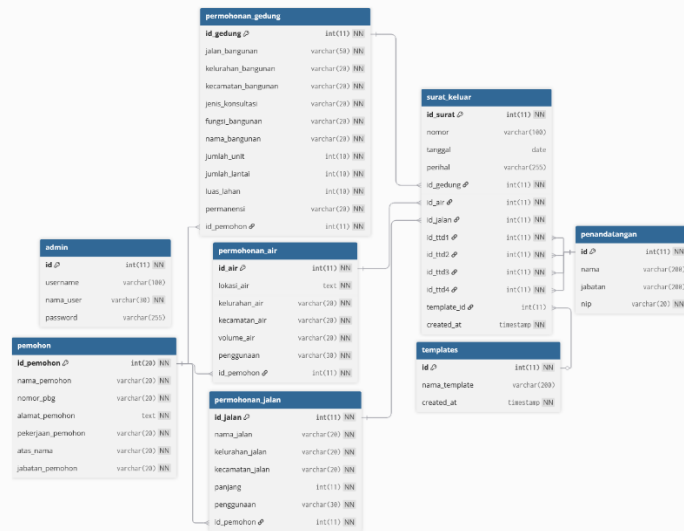
Gambar 10. Entity Relationship Diagram untuk Database Sistem Secara Penuh.
